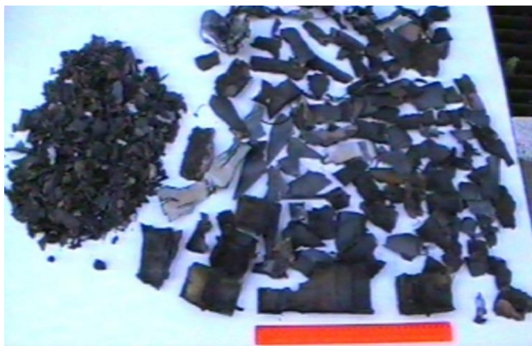
Fig. 6 – Aspectul rachetei RAG-96 și fragmentele rezultate prin autodistrugere
